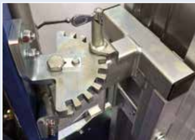
Adaptador para dispositivo de ventosas eléctrico
